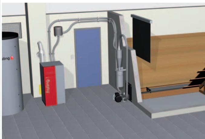
Le système d'aspiration à vis Froling est la solution idéale pour les espaces rectangulaires avec prélèvement frontal. La position horizontale de la vis d'extraction permet d'utiliser de façon optimale le volume de la pièce et de garantir un vidage complet du silo. L'association au système d'aspiration Froling permet en outre une mise en place flexible de la chaudière.
